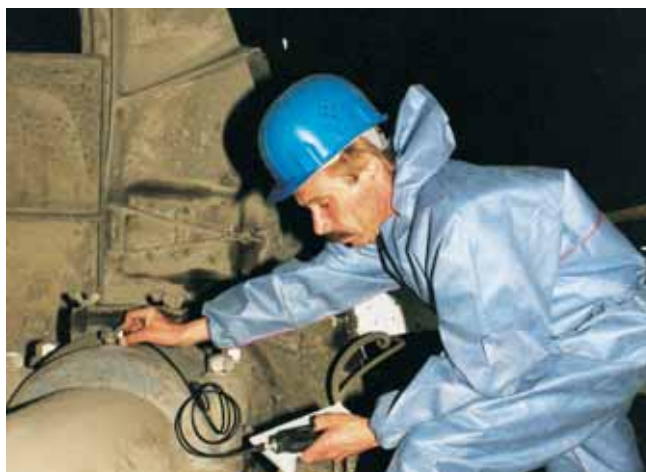
Die Schwingungsmessung der Vorgelegelager. Measuring vibration of the pinion bearings.
