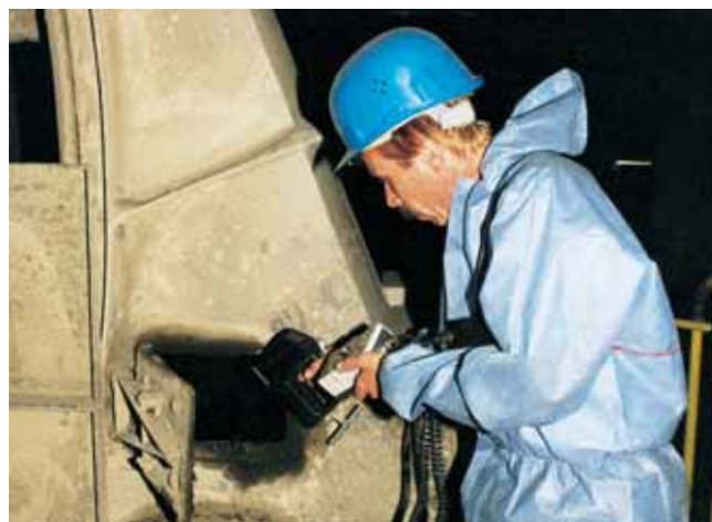
Dynamische Tragbildkontrolle mit Stroboskop. Dynamic checking of the contact pattern with a stroboscope.
